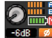
Der RF-Pegel für zwei Kanäle (A und B) wird angezeigt.
