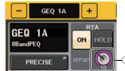
① **Gain-Versatzwert (HPF-METER-Fenster, HPF/EQ-Fenster, GEQ-Fenster, 8BandPEQ-Fenster)**
