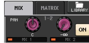
È possibile collegare i parametri principali dei due bus MIX/MATRIX adiacenti con numerazione pari/dispari. Se il bus MIX/MATRIX di destinazione della mandata è impostato su stereo, la manopola sinistra delle due manopole adiacenti TO MIX/MATRIX SEND LEVEL (A LIVELLO MANDATA BUS MIX/MATRIX) viene utilizzata come manopola TO MIX/MATRIX PAN (A PAN MIX/MATRIX) (se nella finestra TO STEREO/MONO è stata selezionata la modalità BALANCE, verrà utilizzata come manopola BALANCE (BILANCIAMENTO)).
