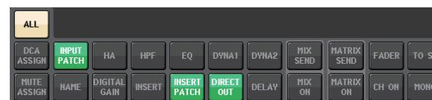
In questa figura gli elementi in verde indicano che i parametri INPUT PATCH, INSERT PATCH e DIRECT OUT sono stati impostati su Safe mediante le impostazioni del parametro Global per INPUT PATCH.
