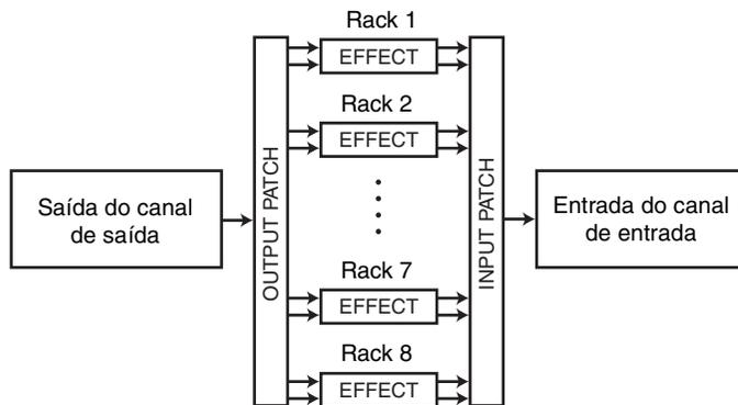
Como opção, você pode atribuir a entrada e a saída do efeito interno à saída/entrada de inserção de um canal desejado (exceto para um canal ST IN), de forma que o efeito seja inserido nesse canal.
