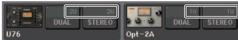
O U76 ocupa dois espaços de rack. Os outros processadores ocupam um espaço. Se você montar um processador Premium Rack no rack, não poderá montar mais nenhum outro processador abaixo desses espaços. Além disso, você não poderá montar um processador de dois espaços em um rack com numeração par.
