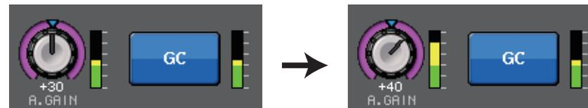
Se o console FOH e o console de monitoramento estiverem compartilhando um dispositivo de E/S, o ajuste do ganho analógico no console FOH não afetará o nível de entrada no console de monitoração. O sinal na rede de áudio é mantido a um nível constante e, portanto, aumentar o ganho analógico o máximo possível reduzirá a base de ruído relativo e melhorará a taxa de S/N.
