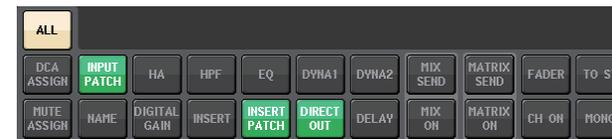
Nesta ilustração, os itens acesos em verde indicam que os parâmetros INPUT PATCH (patch de entrada), INSERT PATCH (patch de inserção) e DIRECT OUT (saída direta) foram definidos como Safe (seguro) pelas configurações de parâmetros globais de INPUT PATCH.
