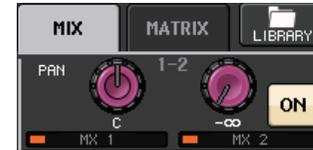
Você pode vincular os principais parâmetros de dois barramentos MIX/MATRIX pares/ímpares adjacentes. Se o barramento MIX/MATRIX de destino de envio for atribuído como estéreo, o botão giratório esquerdo dos dois botões TO MIX/MATRIX SEND LEVEL (nível de emissão para MIX/MATRIX) adjacentes funcionará como o botão giratório TO MIX/MATRIX PAN (panorâmica para MIX/MATRIX). (Se o modo BALANCE for selecionado na janela TO STEREO/MONO, ele funcionará como um botão giratório BALANCE).
