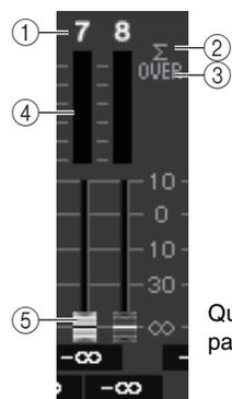
Quando a tecla [ON] para o canal 7 está ligada e a tecla [ON] para o canal 8 está desligada
