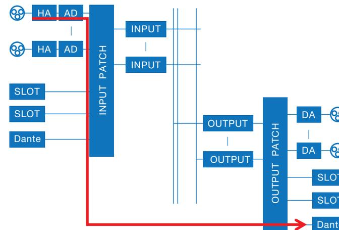
Use a função PORT TO PORT para gerar uma saída de um conector de entrada no painel traseiro para um conector Dante sem enviar o sinal através do mixer. Isso permite o uso das saídas de E/S em consoles da série QL como saídas de E/S para uma rede de áudio.
